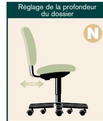
Permet de régler le dossier vers l'intérieur et vers l'extérieur pour en accroître la profondeur.
