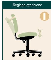
Permet de régler automatiquement l'angle du siège et du dossier, tout en maintenant un rapport d'inclinaison 2:1, ce qui offre un support optimal du dos et un soulèvement minimal du siège.
