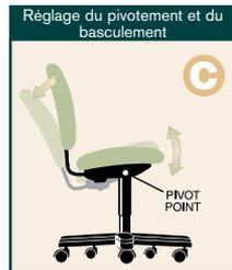
Permet de placer le point de pivotement directement au-dessus du centre de la base et de se pencher vers l'arrière en position assise.
