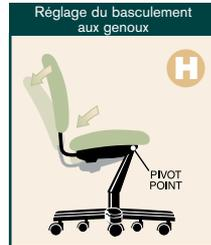
Permet d'incliner complètement le siège, tout en gardant les pieds confortablement sur le plancher. Le point de pivotement est placé près de l'avant du siège.
