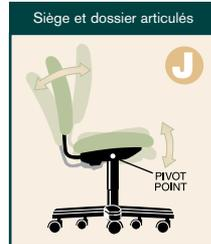
Permet de régler l'angle du siège et du dossier de façon indépendante au moyen d'un seul levier.
