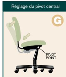
Permet d'incliner la chaise à un angle plus naturel que le réglage traditionnel du basculement. Le point de pivotement de la chaise est placé légèrement vers l'avant de la chaise.
