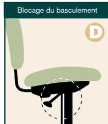
Permet de bloquer le siège et le dossier en position verticale.
